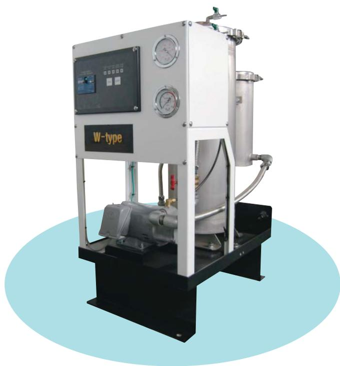
荷電凝集フィルター「NWシリーズ」は交流低電圧を印加した電極間に液体を流す事で、液体中のコンタミ分を凝集粗大化し、フィルターで捕捉します。
